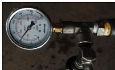
**Gambar 2.** Tahapan uji tekan pada 100 bar (sumber : dokumen pribadi)
