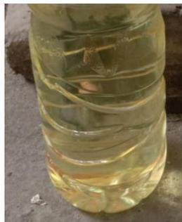
**Gambar 15.** Air yang terbawa oleh tabung penyimpan dan terjebak di dalam separator (sumber: dokumen pribadi).
