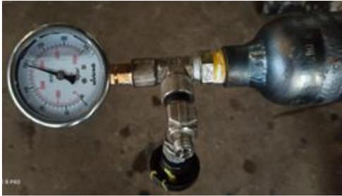
**Gambar 3.** Tahapan uji tekan pada 200 bar (sumber : dokumen pribadi)
