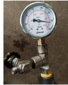
**Gambar 4.** Pengujian tekan menggunakan Hydrotest Pump hingga tekanan maximal 320 bar (sumber : dokumen pribadi)
