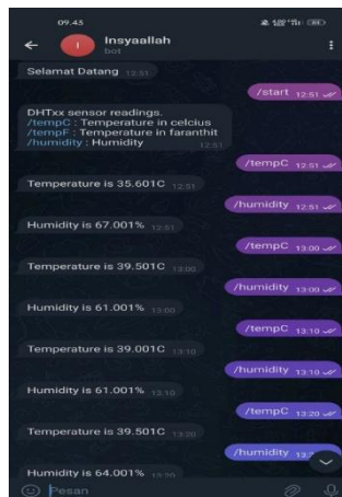
Gambar 5. Tampilan Perintah dan Hasil Pembacaan Suhu dan Kelembaban di Layar Handphone Melalui Aplikasi Telegram.
