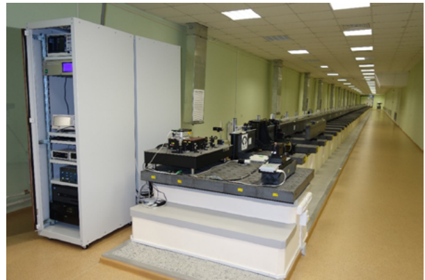
Рис. 3. Эталонный измерительный комплекс длины до 60 метров на основе фемтосекундного лазера и измерительного базиса ГЭТ 199–2018 [12]
