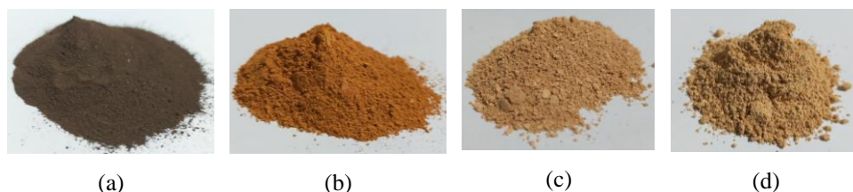
Figure 3. The synthesized of materials \text{Fe}_3\text{O}_4 (a), MIL-100(Fe) (b), MIL-100(Fe) \text{@Fe}_3\text{O}_4 (c), and MIL-100(Fe) \text{@Fe}_3\text{O}_4 -CTAB (d)
