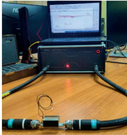
**Рис. 9.** Фотография измерительной установки при измерении модуля КПЛ с кристаллом ниобата лития с электродами
