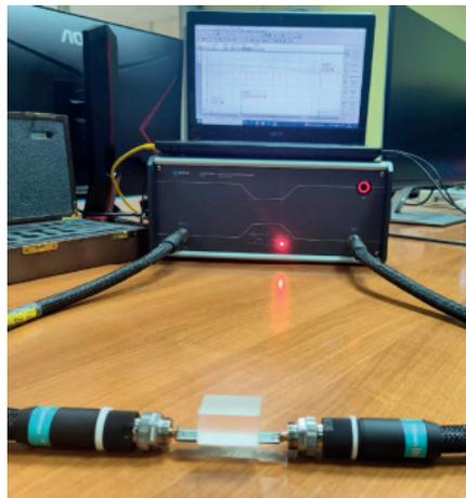
Рис. 3. Фотография измерительной установки с включенным модулем с кристаллом кварца
