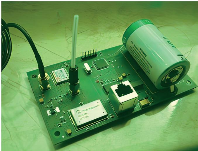
**Рис. 5.** Внешний вид платы сбора данных с датчиков и передачи их по радиоканалу
