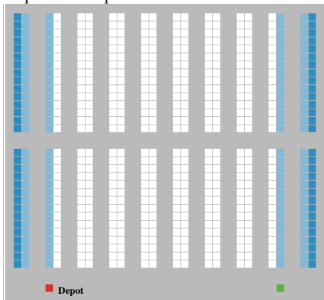
Gambar 3 Penyimpanan Berbasis Kelas Pada Strategi within aisle B Dengan Proporsi Alokasi Ruang Simpan (A:10%; B:20%; C:70%)
