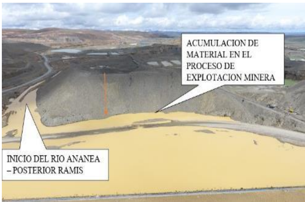
Figura 7. Vista tomada el día 26 de noviembre del 2021, se aprecia la laguna Sillacunca drenando sus aguas al río Ananea y la vía Ananea - La Rinconada afectada por no tener canales de drenaje (Fuente: informe técnico N°019-2021-GR PUNO-ORGRDS).
