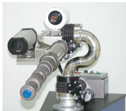
Figura 23 - UGV antincendio e particolare del cannone di erogazione con telecamera per puntamento
