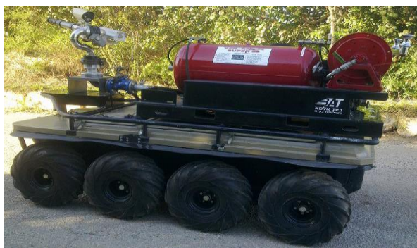
Figura 23 - UGV antincendio e particolare del cannone di erogazione con telecamera per puntamento
