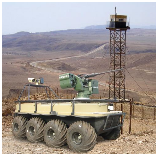
Figura 25 - UGV con mitragliatore da campo
