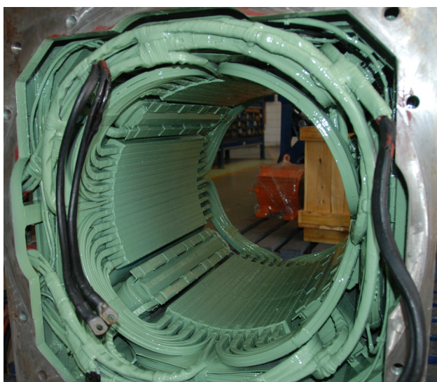
Figura 10 – Pintura interna em um motor elétrico.
