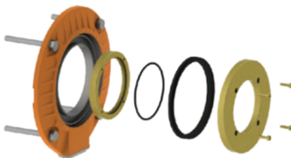
Figura 9 – Combinação da vedação por retentor e labirinto.
