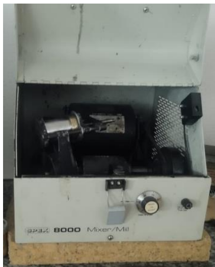
Figura 20. (a) Moinho SPEX 8000M aberto com o jarro pronto para moagem; (b) Jarro preparado para moagem.
