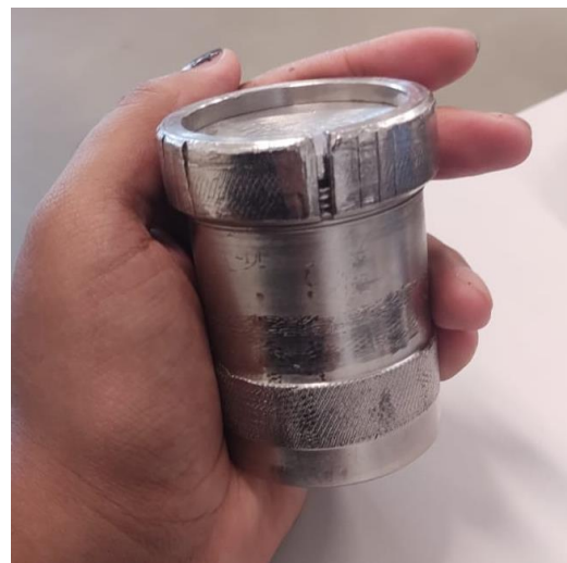
Figura 20. (a) Moinho SPEX 8000M aberto com o jarro pronto para moagem; (b) Jarro preparado para moagem.
