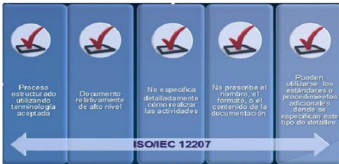
Ilustración 40: Características norma ISO/ IEC 12207. Fuente: Diseño propio.
