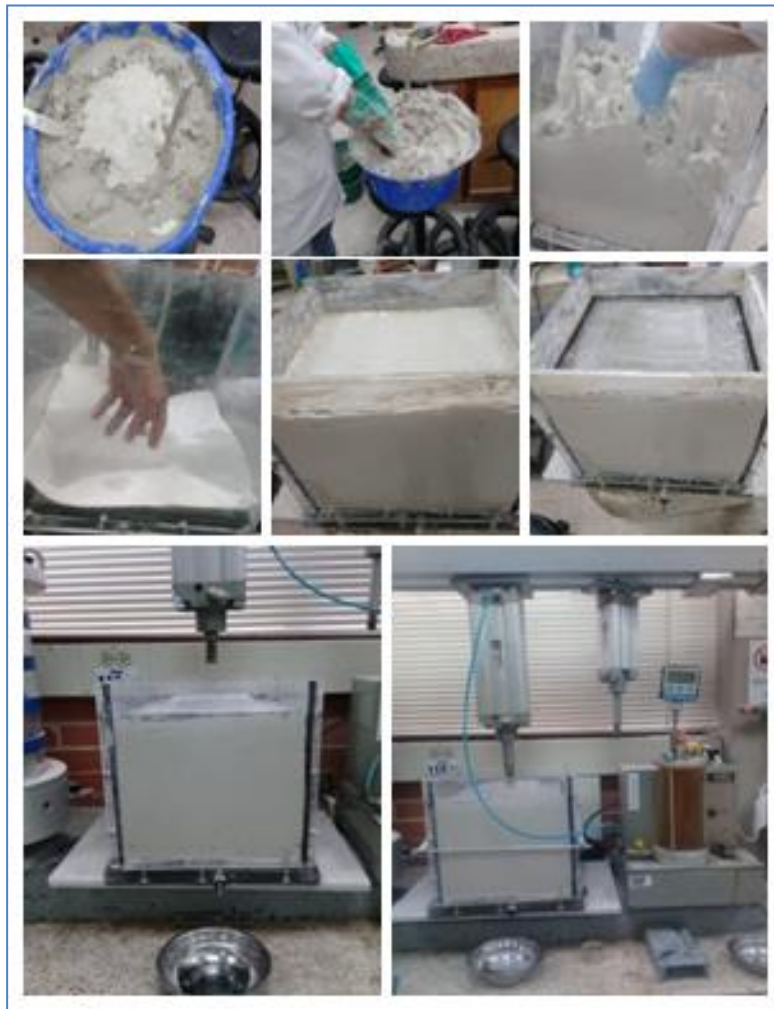
Figura 19. Reconstitución y Preconsolidación de la Muestra de Suelo
