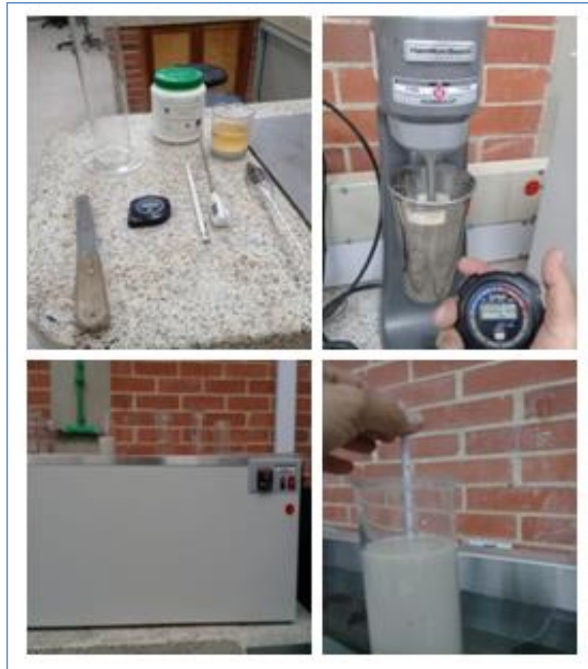
Figura 16. Ensayo de Granulometría por Hidrómetro Fuente: Propia
