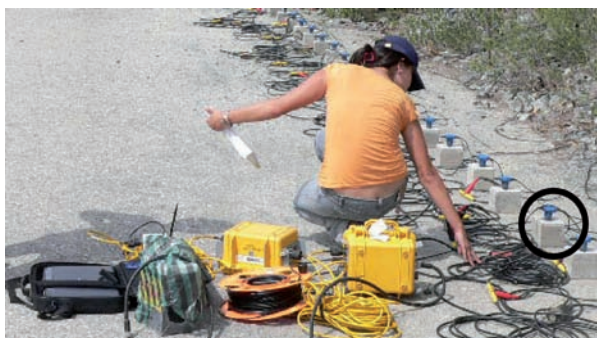
FIGURA 5. Tendido sísmico para la adquisición en los gneises de la Asociación Sierra Nevada.
