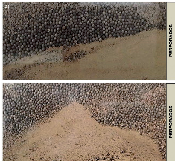
Figura 4. a) y b) Primer y Segundo Patrón de Distribución de Finos de propante generados a nivel de laboratorio.
