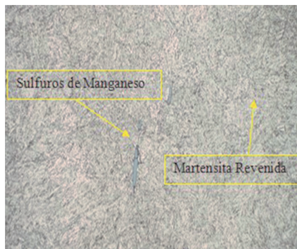
Figura 2. Microestructura del Acero AISI SAE 4330, A 1400X
