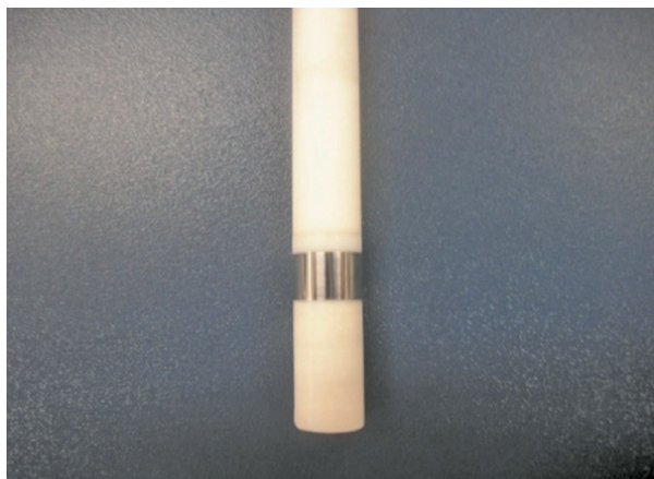
Figura 1. Eje del cilindro rotatorio con la probeta preparada
