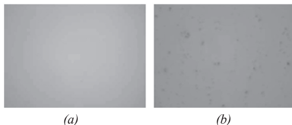
Figura 1. Micrografía de una película de PLA/HAP tomada a 5X. (a) Cristal de cuarzo sin recubrimiento, (b) cristal de cuarzo con recubrimiento.
