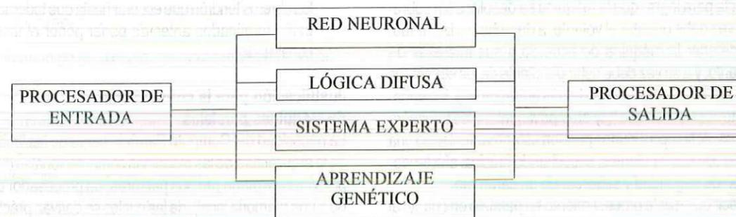
Figura 1. Esquema de procesamiento de una red neuronal híbrida que comparte Información con otras tecnologías de Inteligencia Artificial
