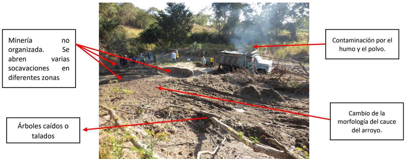
**Figura 6-4 Operación de extracción ilegal de arena en el arroyo Cambimba. Fuente: CARSUCRE**
