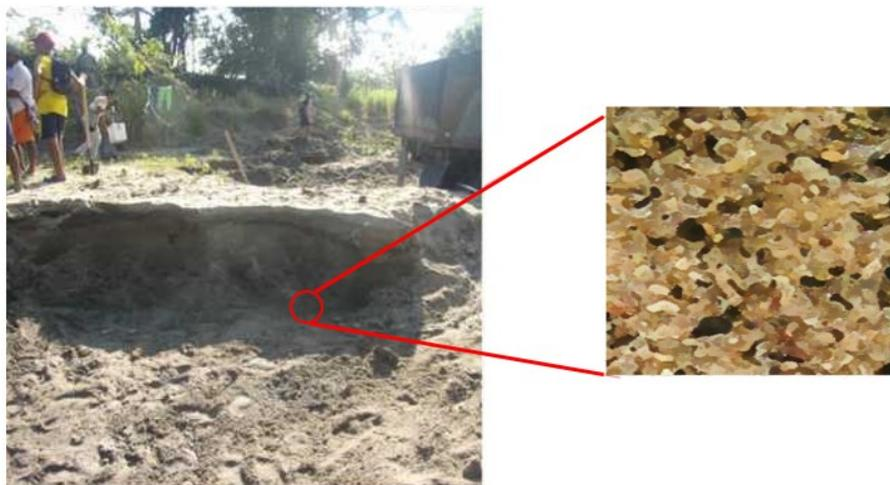
**Figura 6-1** Caracterización de la zona de explotación de arena. A la izquierda una terraza de arena explotada y a la derecha una fotografía de la arena lavada en alta resolución. (Fuente Propia)
