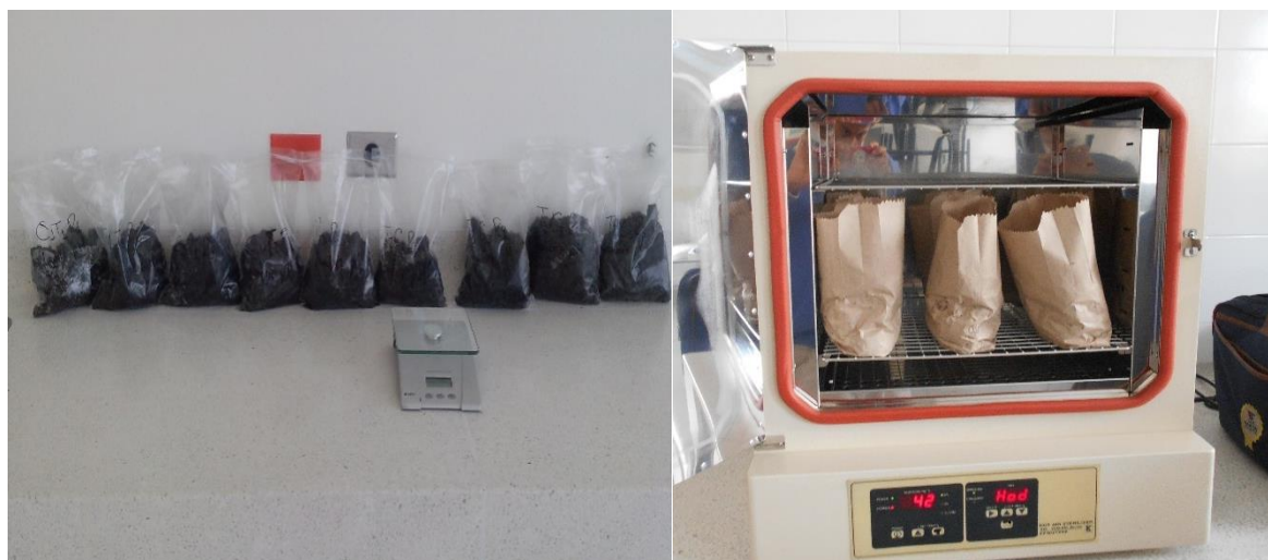
Figura 11: Secado de muestras para determinación de humedad. Laboratorio de suelos Universidad Juan de Castellanos (Tunja)
