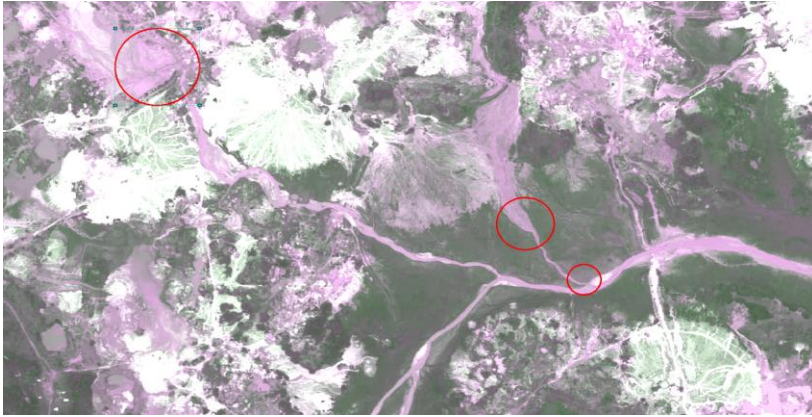
Figura 37. Imagen de gran escala 1:5000 pixel de 50 cm identificación de cambio de cauce y posible inundación, fuente imagen tomada de la biblioteca FAC combinación 2, 3,2.
