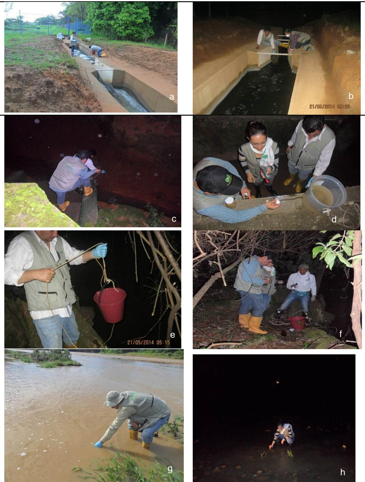
Figura 15. (a-b) Aforo caudal salida PTARD. (c-d) Toma de muestra caño Usivar, aguas arriba. (e-f) Toma de muestras aguas abajo. (g) Río Charte aguas abajo. (h) Río Charte, aguas arriba.
