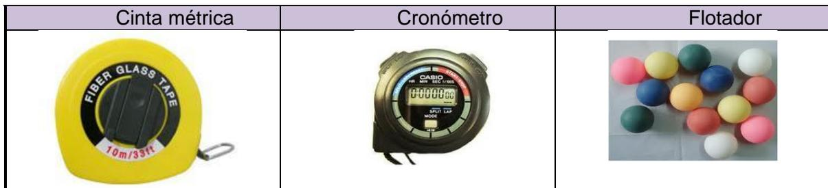
Figura 17. Elementos con los cuales se realizó el aforo.
