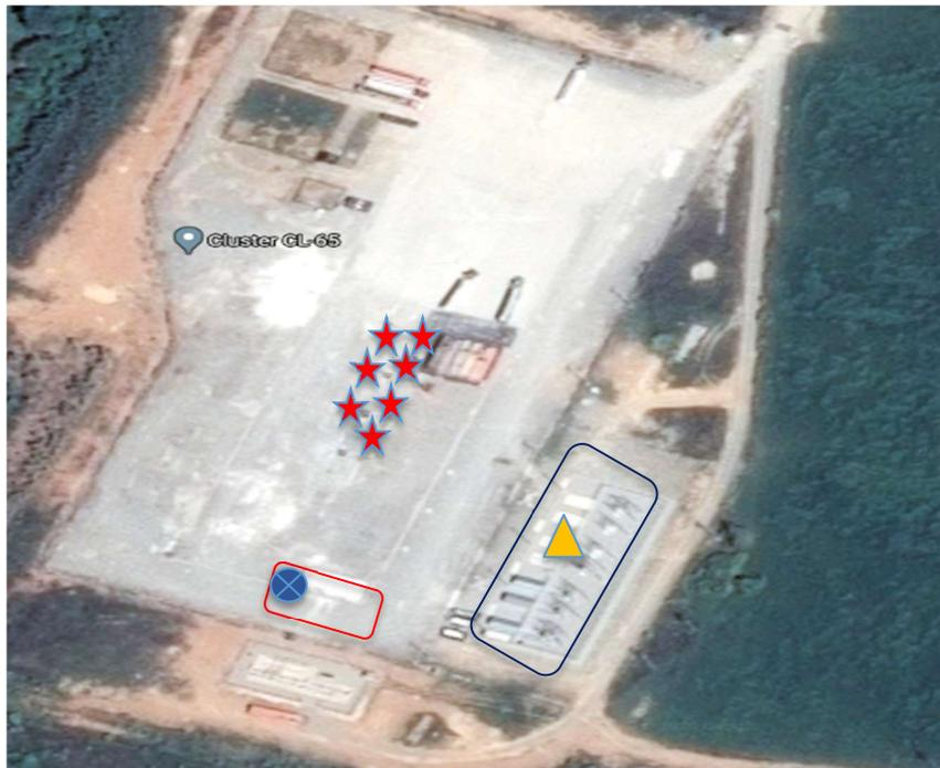
La figura 6, indica la distribución y ubicación geográfica de los pozos que conforman el clúster 65, las estrellas representan los 7 pozos; en el costado inferior derecho con un triángulo amarillo, se ubica la subestación eléctrica y un círculo azul representa el sistema de recolección y transporte de crudo hacia la estación de tratamiento.
