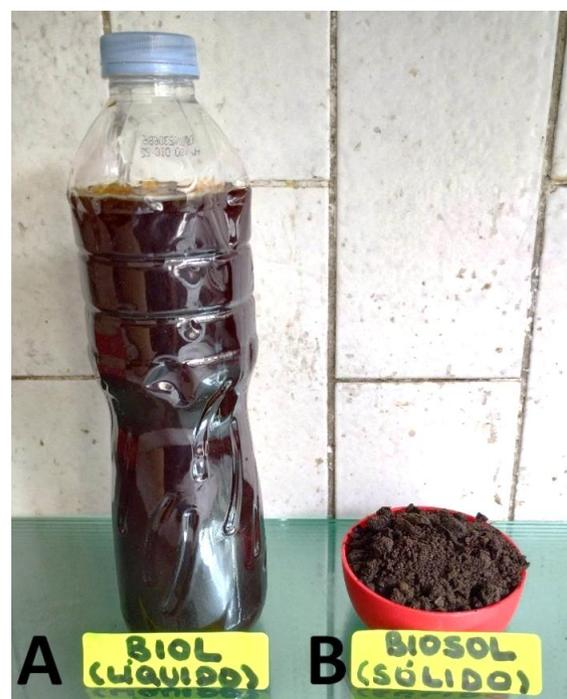
**Figura 4.** Muestras de digestatos obtenidos: (A) Biol (líquido), (B) Biosol (sólido).
