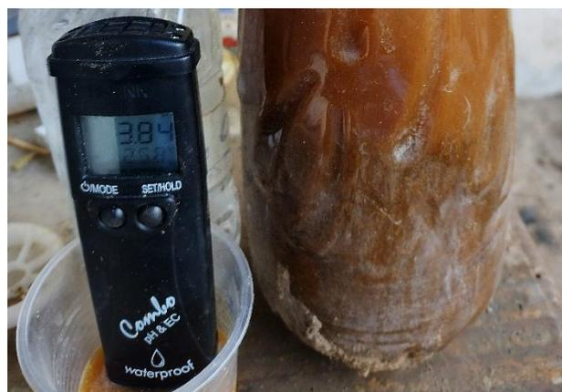
Figura 3. Medición de pH del digestato líquido.
