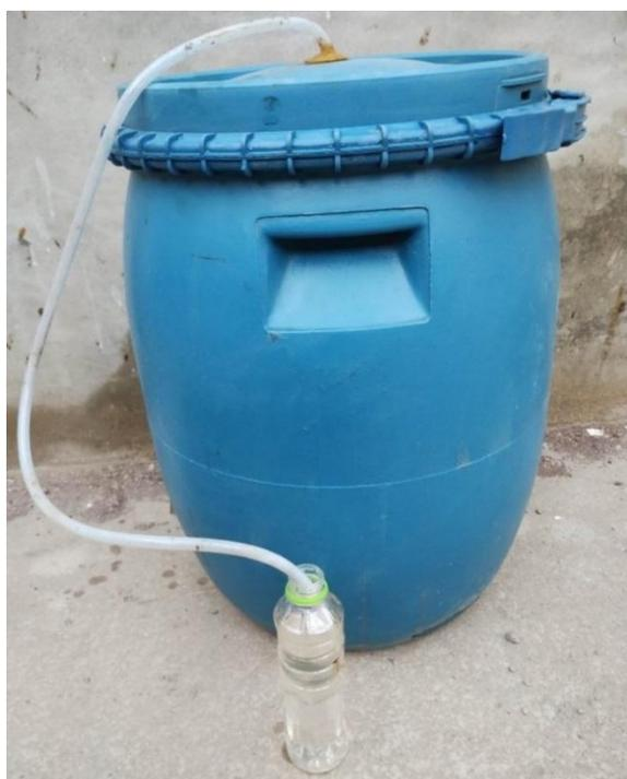
**Figura 1.** Biodigestor tipo batch de 50 L.
