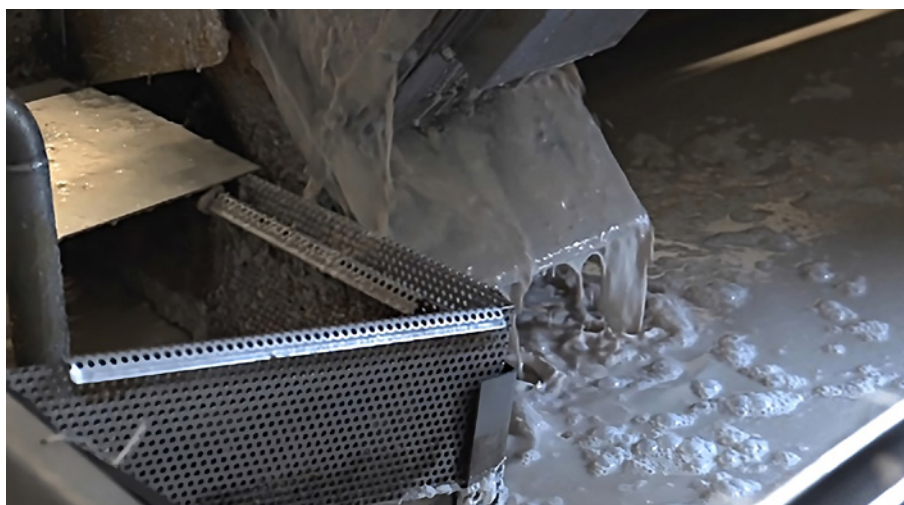
Fig. 2. Macchina di triturazione e spremitura per separare le parti organiche e inorganiche (foto di Design Differente).
