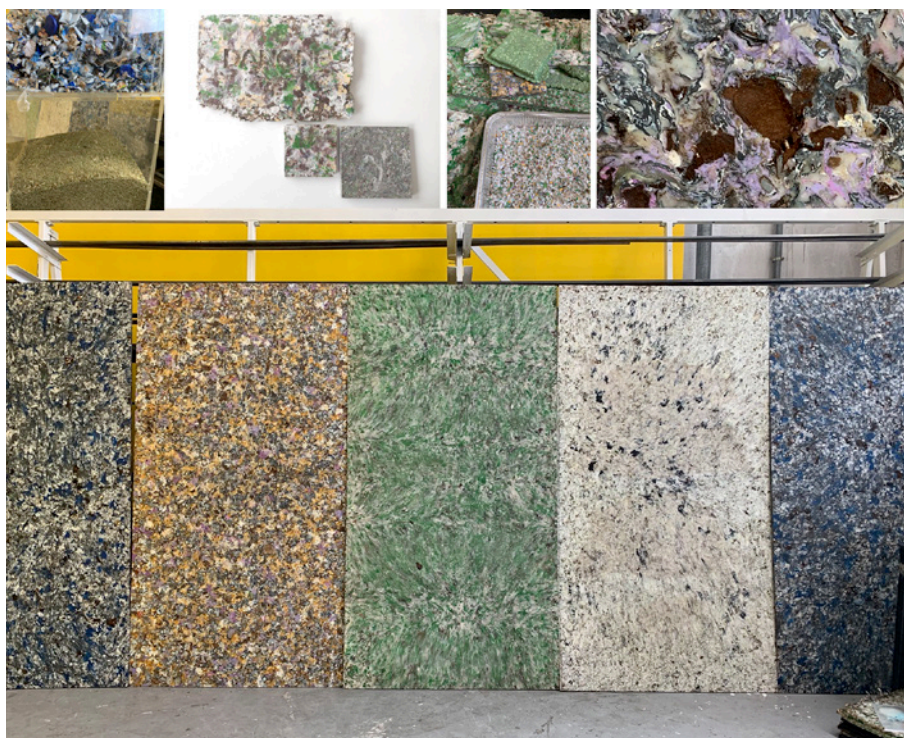
Fig. 3. Particolare del neomateriale prodotto nell'ambito del progetto CAPitoli Urbani. Il materiale è ottenuto dal riciclo di rifiuti plastici non omogenei e di altri materiali come alluminio o Tetrapack (elab. degli AA.).
