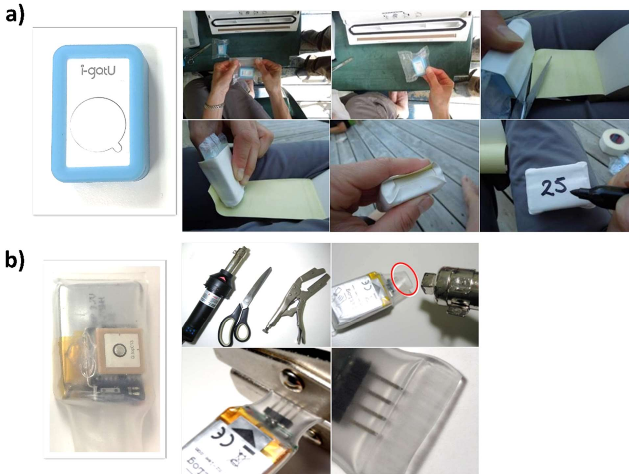
Figure 1 -17 Emballage des GPS : a) iGotU GT-120 emballé sous vide et b) CatLog Gen 2 emballé dans du tube plastique thermorétractable (photos : David Pelletier, Sarah Doiron, manuel d'instructions des CatLog Gen 2).
