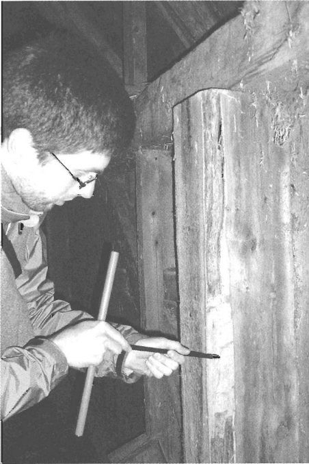
Fig. 2 Échantillonnage d'une poutre de grange à l'aide d'une sonde Pressler
