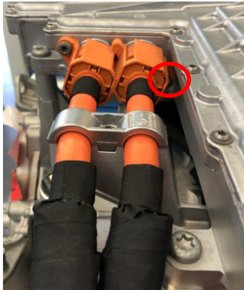
Abbildung 50: Verdeckte Schraube zur Fixierung der Starkstromkabel am EAA
