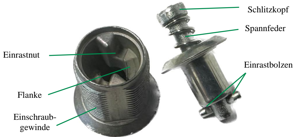
Abbildung 80: Verwendeter Camloc Schnellverschluss Modell 99F des Herstellers Benloc Fastener Technik GmbH & Co. KG (links: Haltenocke, rechts: Verschlusszapfen)
