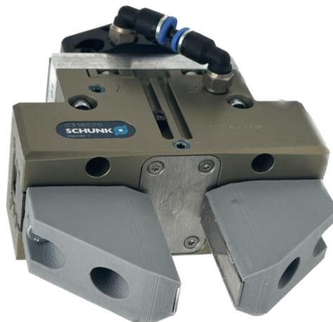
Abbildung 70: Parallelgreifer zur Entfernung der Einlegedichtungen am Dummy-EAA
