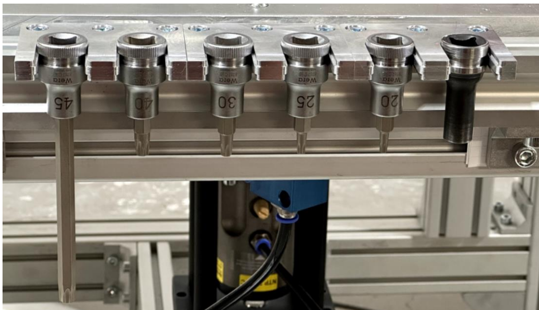
Abbildung 73: Mit Umlaufnut versehene Bitnüsse im Bitnusswechselsystem (v.l.n.r.: T45 Langbit, T40, T30, T25, T20, Sonderanfertigung E10)
