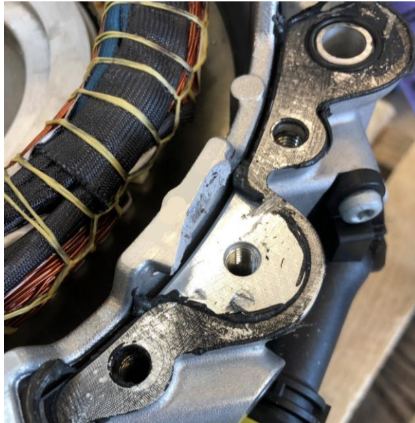
Abbildung 54: Nach Demontage des Gehäusedeckels zurückbleibende Dichtmasse auf aufgerauten Stirnflächen des Hauptgehäuses
