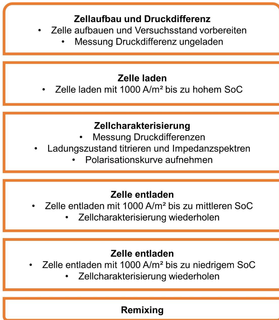
Abbildung 3.15: Ablauf der experimentellen Charakterisierung der Strömungsfelder.
