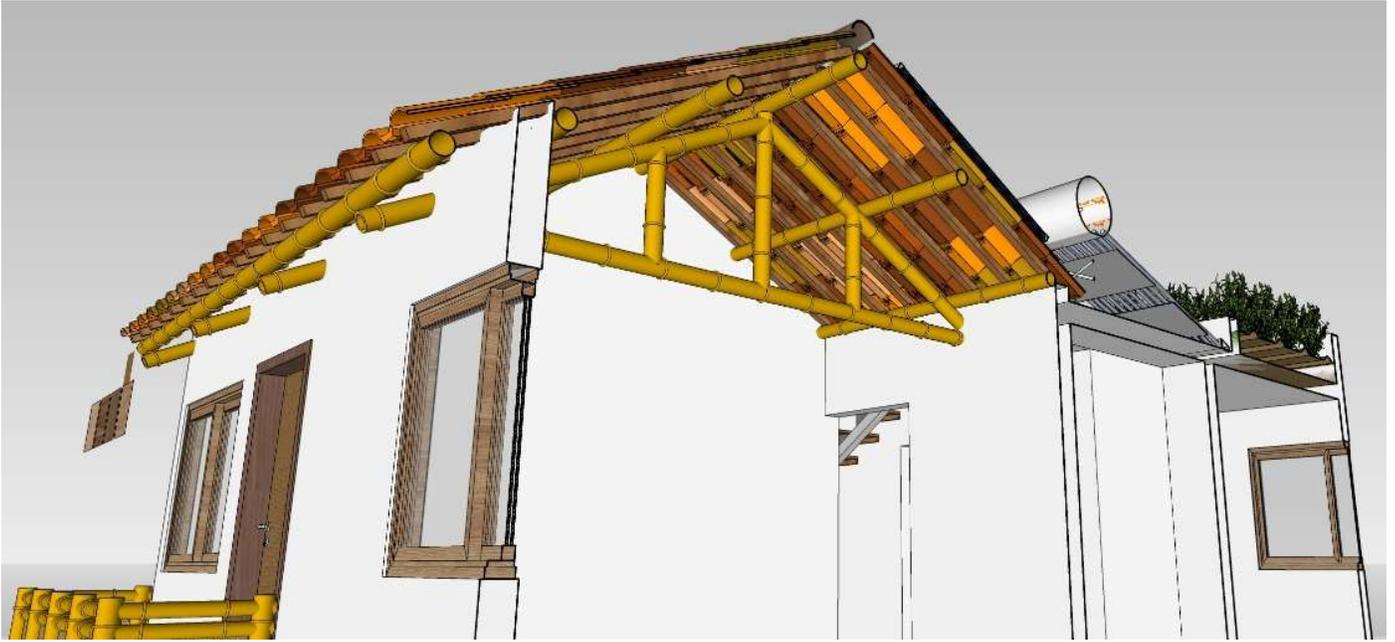
Figura 146. **Detalle de estructura de techos**
