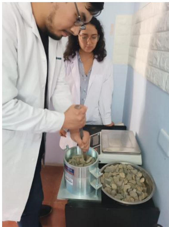
Imagen N°10.- Se está colocando en el molde la muestra por capas para el Ensayo de Proctor + agregado fino
