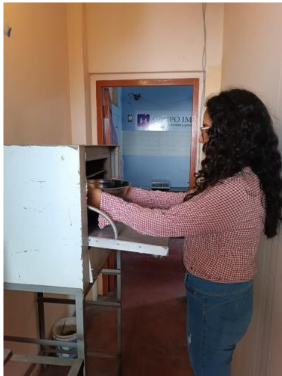
Imagen N°14.- Se está colocando en la estufa la muestra
