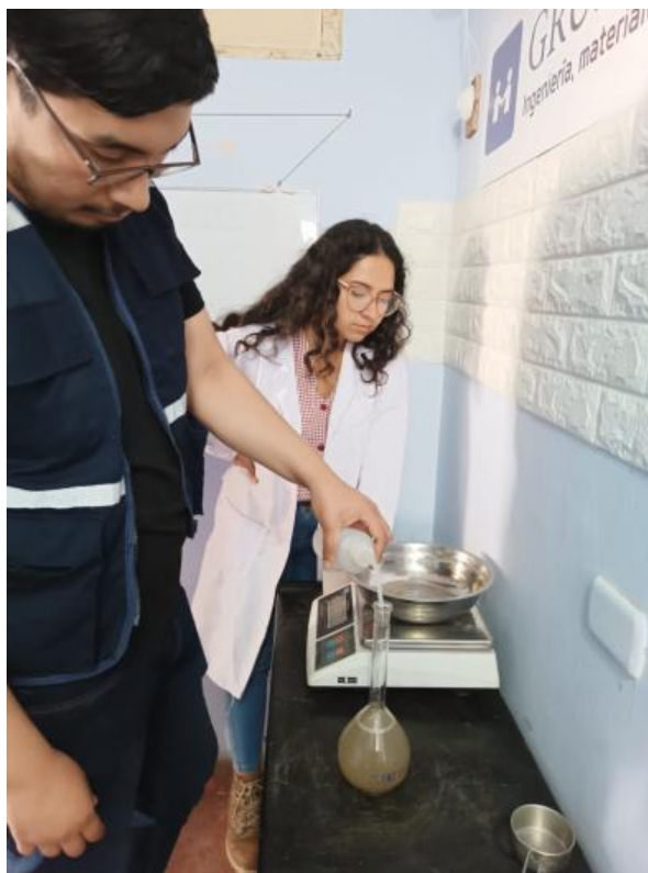
Imagen N°22.- Se está colocando agua destilada en al fiola para el ensayo de Gravedad Especifica
