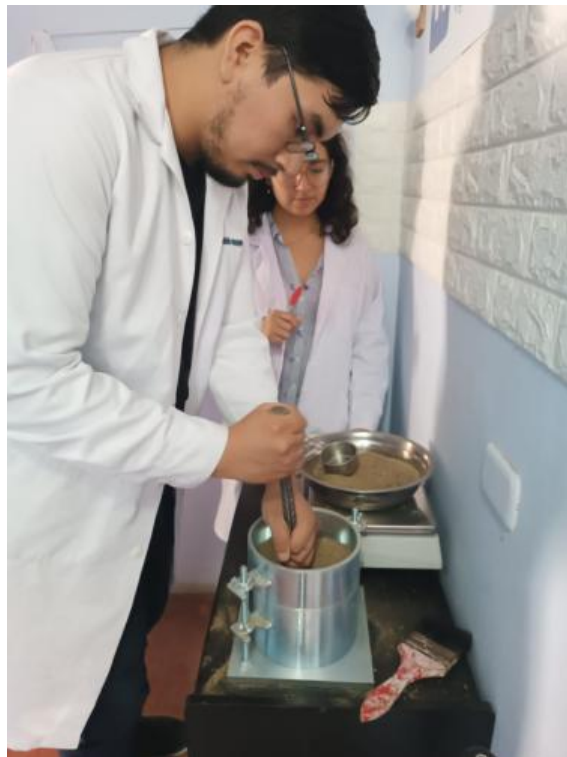
Imagen N°08.- Se está colocando en el molde la muestra por capaz para el Ensayo de Proctor + agregado fino
