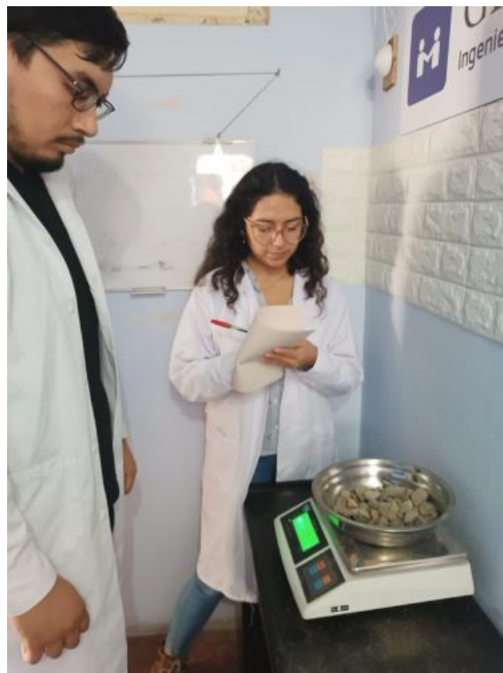
Imagen N°02.- Se está pesando en la balanza el agregado grueso
