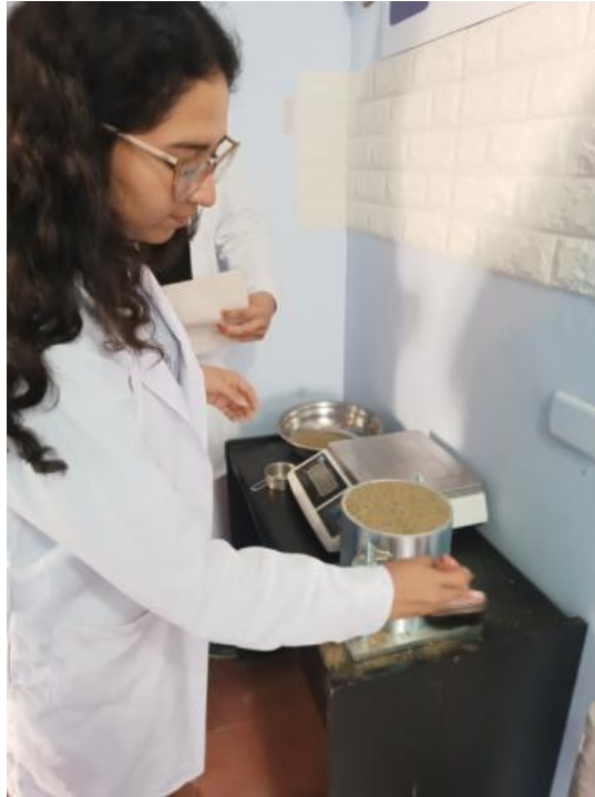
Imagen N°09.- Se está colocando en el molde la muestra para el Ensayo de Proctor + agregado fino
