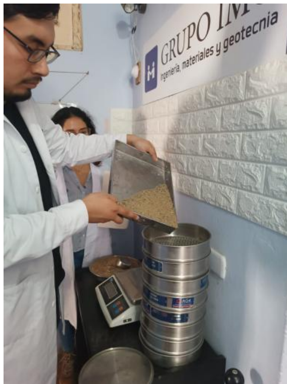
Imagen N°12.- Se está colocando el agregado fino por la malla para Granulometría
