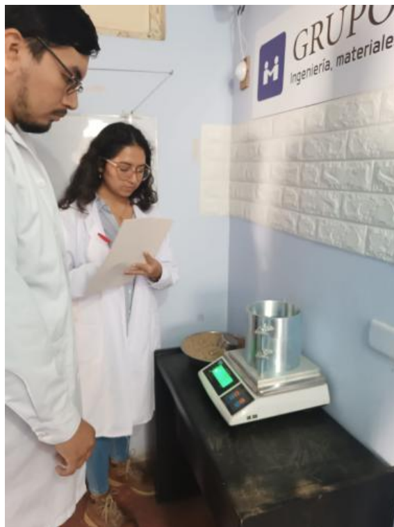
Imagen N°06.- Se está pesando en una balanza el molde para el ensayo de Proctor
