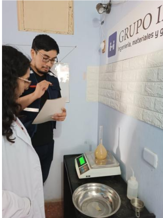
Imagen N°19.- Pesando la Fiola + agua + muestra
