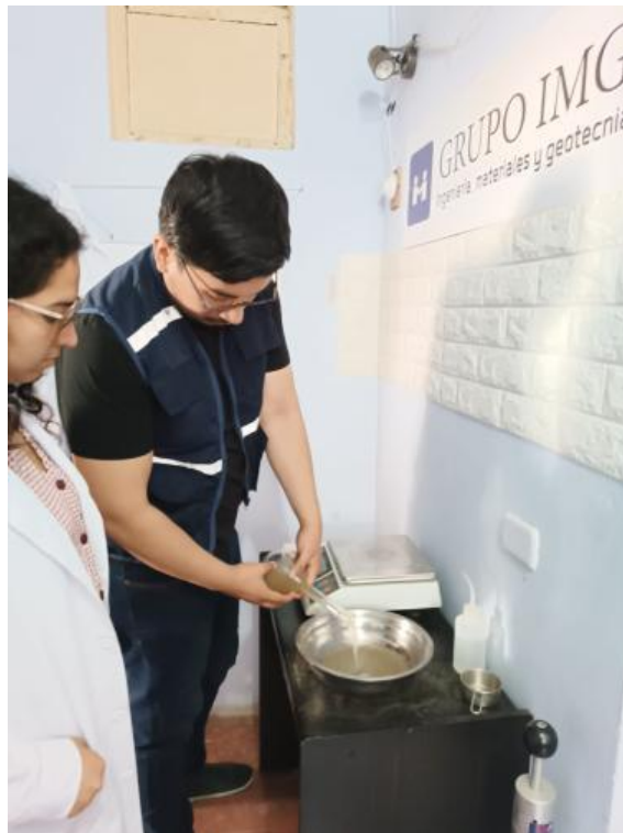
Imagen N°20.- Se está eliminando el agua de la fiola
