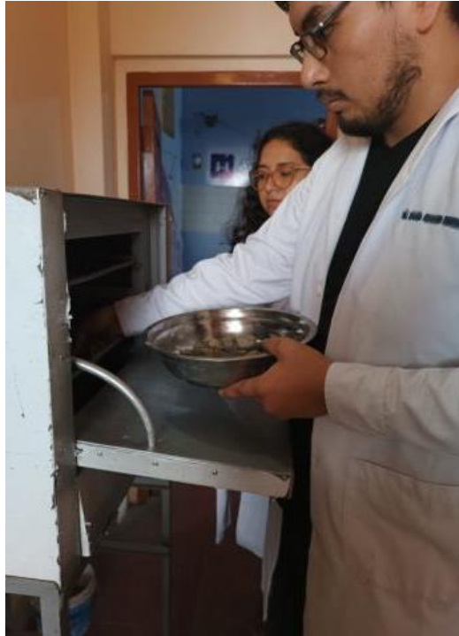
Imagen N°01.- Se está colocando en la estufa el agregado grueso
