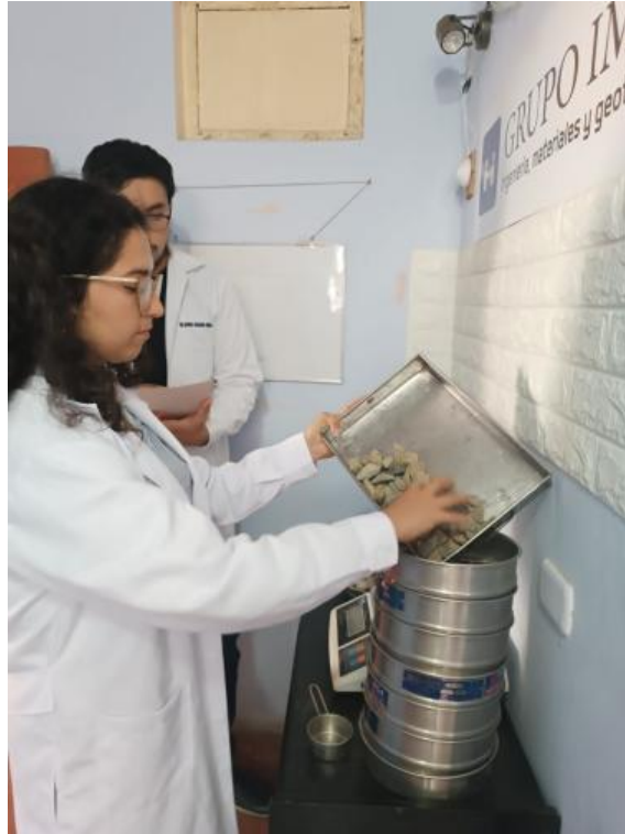
Imagen N°13.- Se está colocando el agregado grueso por la malla para Granulometría
