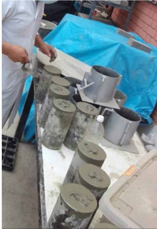
Imagen N°25- Se llenado de probetas de concreto.
