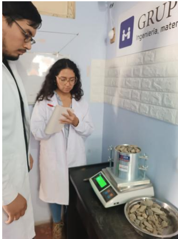
Imagen N°11.- Se está pensando en una balanza el molde para el ensayo de Proctor + agregado grueso
