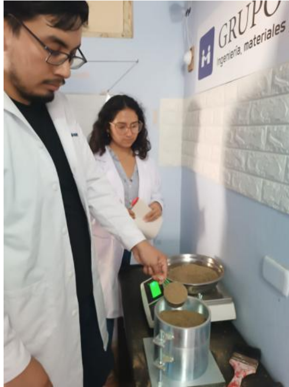
Imagen N°07.- Se está colocando en el molde para el ensayo de Proctor + agregado fino
