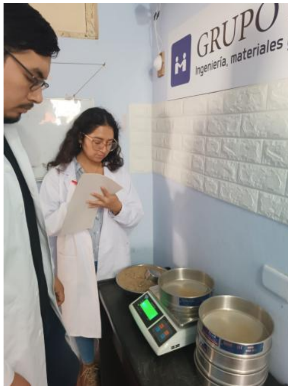
Imagen N°04.- Se está pesando en una balanza lo retenido en cada malla (agregado fino)
