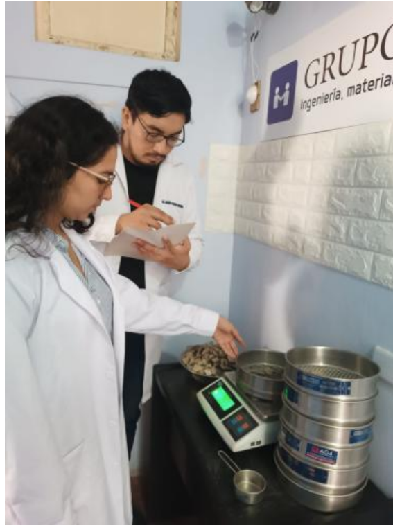
Imagen N°05.- Se está pesando en una balanza lo retenido en cada malla (agregado grueso)
