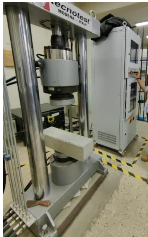
Imagen N°28.- Codificando las probetas para el Ensayo de Resistencia a la flexión
