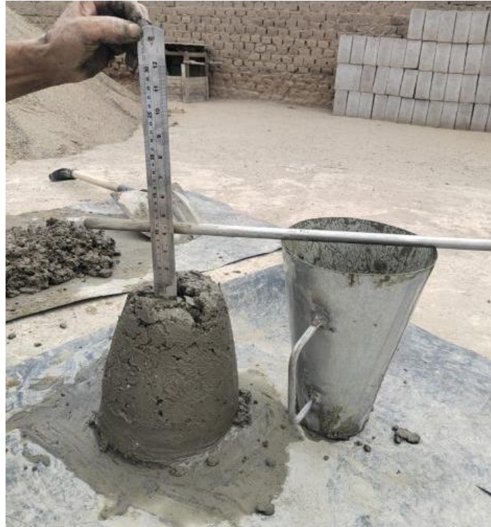
Imagen N°23.- Se está midiendo el asentamiento del hormigón
