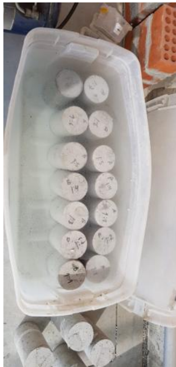
Imagen N°26.- Se muestran las probetas curadas en agua
