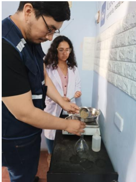
Imagen N°16.- Se está colocando la muestra en la fiola ya pesada para en ensayo de Gravedad Especifica
