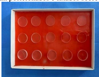
Figura 2 - Discos foram posicionados e fixados sobre uma camada de cera 7
