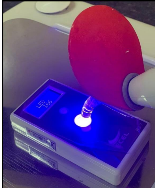
Figura 6 – Fotografia aproximada do momento da leitura de irradiância evidenciando o íntimo contato entre a superfície do receptor fotossensível do radiômetro e da ponteira condutora de luz do aparelho de fotoativação.
