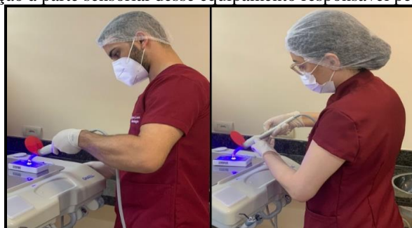
Figura 5 – Fotografia dos dois avaliadores calibrados realizando o posicionamento do radiômetro em uma superfície plana e estabilizada para permitir o contato centralizado da ponteira condutora de luz dos fotoativadores em relação à parte sensorial desse equipamento responsável pela leitura da irradiância.
