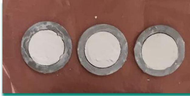
Foto 1: Pastas manipuladas inseridas em anéis metálicos.
