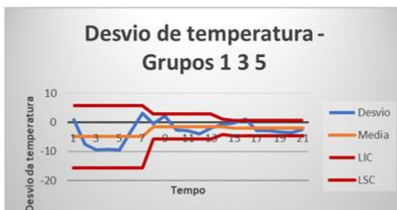
Figura 3: Média de temperaturas da caixa térmica ao longo do tempo. X//: média das médias; LSC: limite superior de controle; LIC: Limite inferior de controle.
