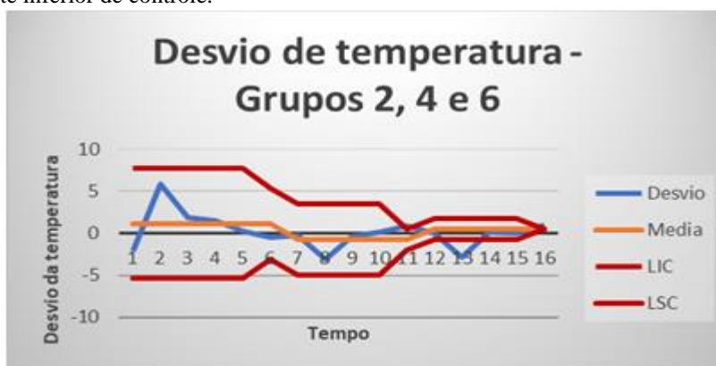
Figura 5: Média de temperaturas da caixa térmica ao longo do tempo. X//: média das médias; LSC: limite superior de controle; LIC: Limite inferior de controle.
