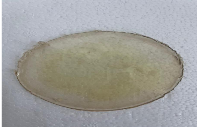
Figura 2: Filme mucoadesivo obtido por secagem em estufa a 50° por 2 horas e 20 minutos.
