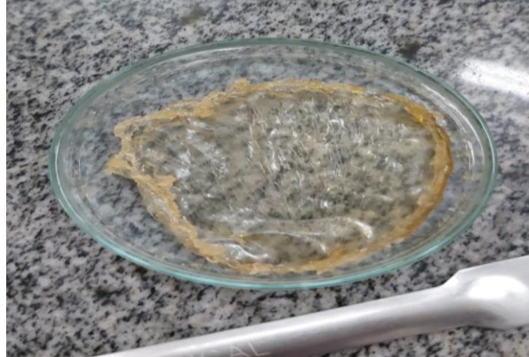
Figura 1: Filme mucoadesivo obtido por secagem em estufa a 50 °C overnight .
