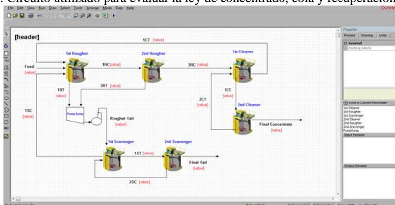
Con el circuito seleccionado, con una ley de cobre en el concentrado y en las colas de 28,6% y 0,15%, respectivamente y con porcentaje de recuperación de cobre de un 86,5%, se evaluó el efecto de ley de  $FeS_2$  alimentado y tiempos de residencia para cada etapa en términos de recuperación de cobre, leyes de cobre en el concentrado y en colas.
