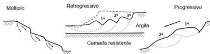
Figura 6 – Escorregamentos rotacionais múltiplos.
