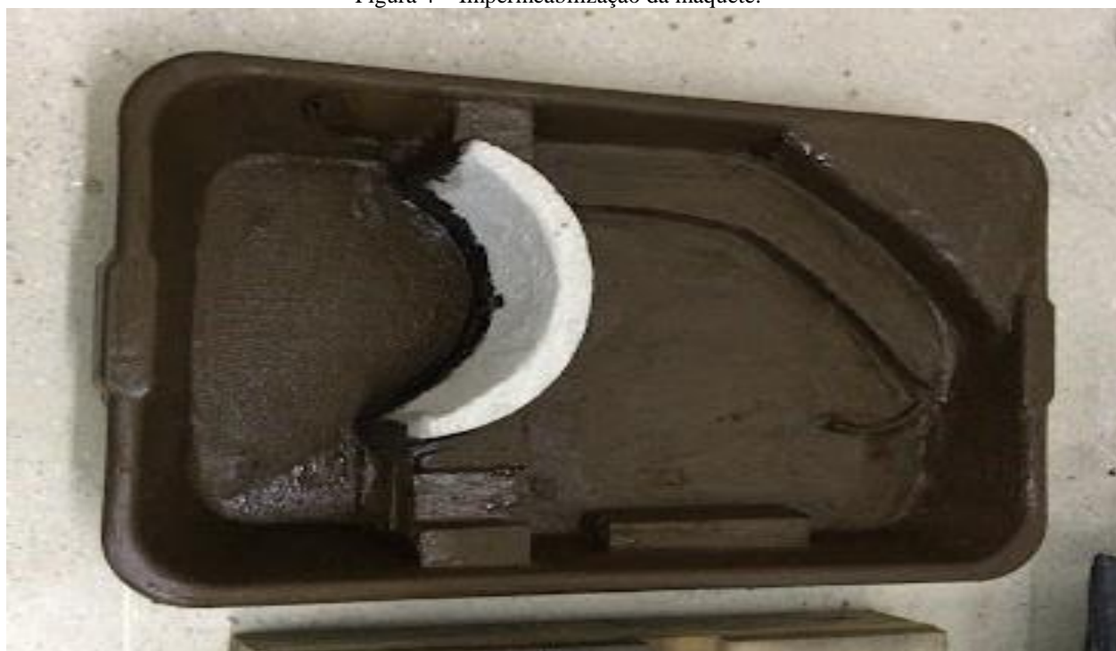
Figura 4 – Impermeabilização da maquete.
