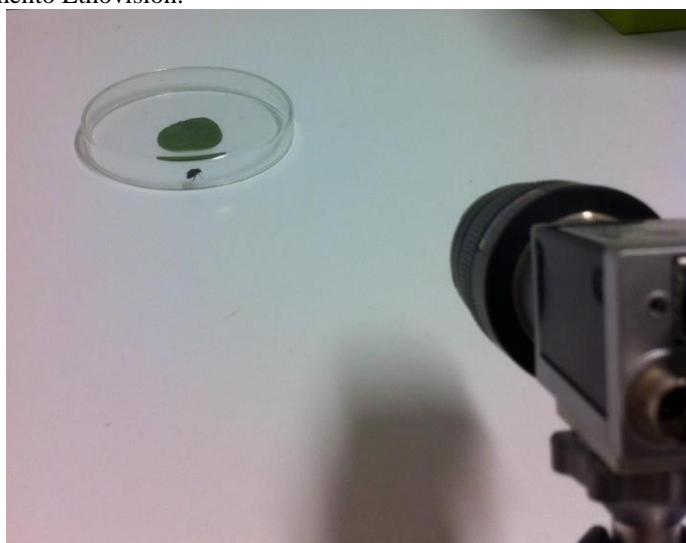
Figura 1: monitoramento de fêmea de Harmonia axyridis em placa de Petri com disco foliar dealgodoeiro, com auxílio do equipamento Ethovision.
