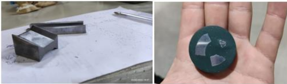
Figura 13 – (a) Polo e, (b) frações embutidas para análise de Somaloy® 5P, 3P e, 1P respectivamente em sentido horário (amostras embutidas, lixadas e polidas com pasta diamantada).
