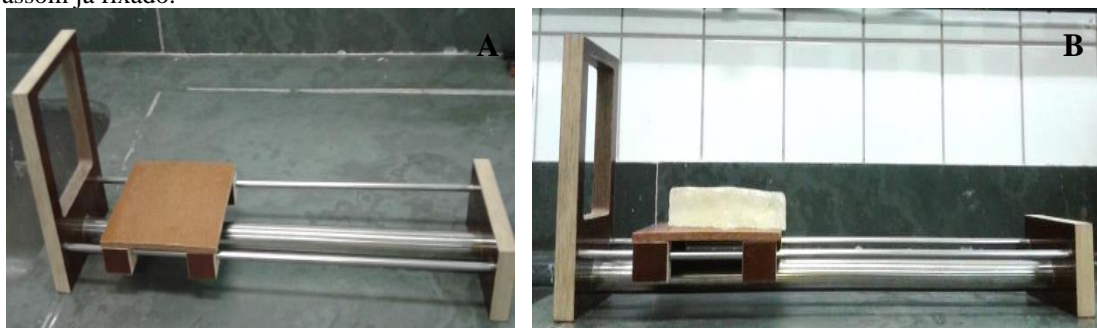
Fig.3. Fotografias preliminares da montagem do protótipo do SISP. (A) Peças montadas; (B) protótipo com suporte para ultrassom já fixado.
