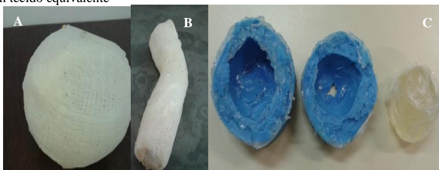
Fig. 4: Órgãos sintéticos e molde. (A) Bexiga, (B) o reto e (C) os moldes para a confecção das próstatas e uma próstata confeccionada com tecido equivalente
