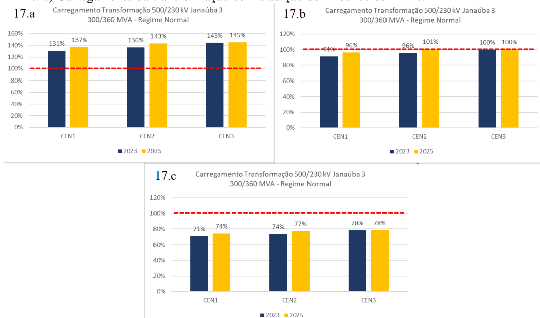
Fig. 17 – a) Carregamento dos ATRs em regime normal no atual estado, com 2 atrs. Violaçãp da transformação 500/230kV Janaúba 3. b) Carregamento da transformação com a adição do 3º banco de ATRs. c) Carregamento da transformação com a adição do 4º banco de ATRs.
