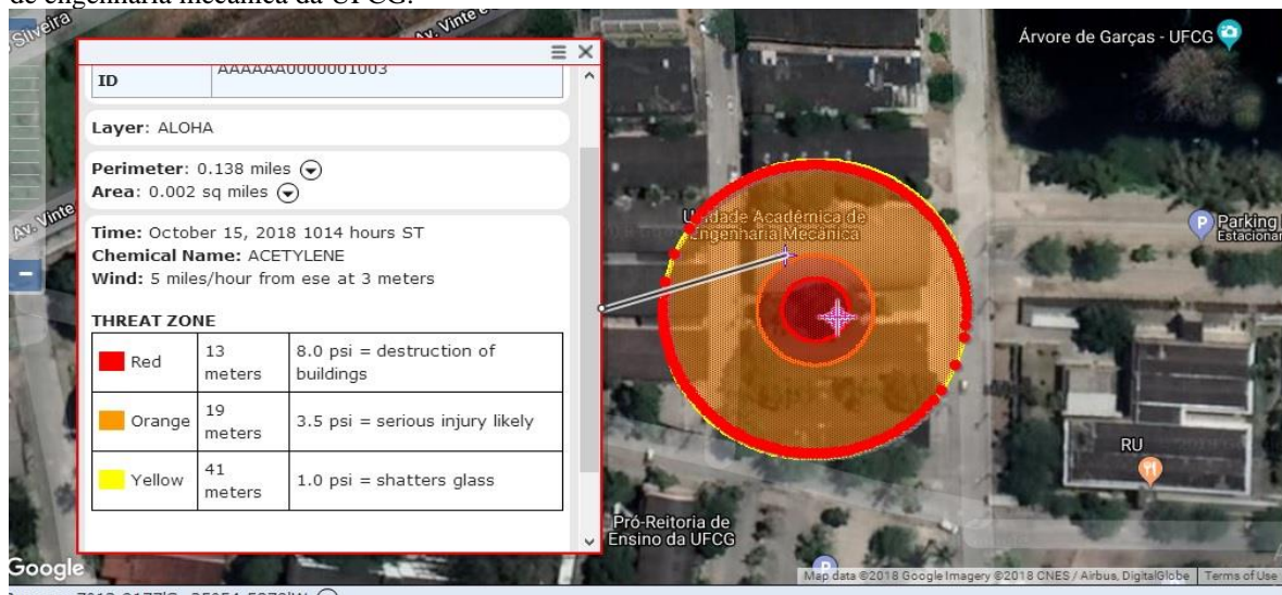
Figura 3: Projeção das energias de sobrepressão liberada pela explosão do gás acetileno no departamento de engenharia mecânica da UFCG.
