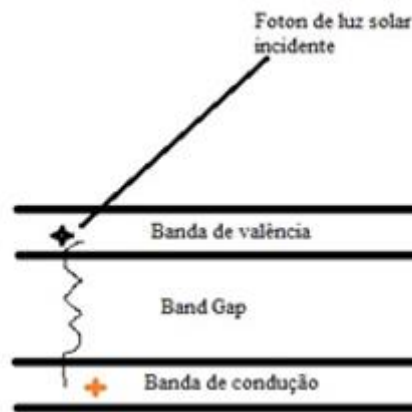
Fig.1-Esquemático ilustrando o Efeito Fotoelétrico.
