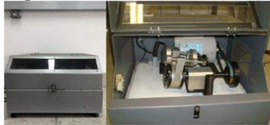
Figura 1. Moinho de bolas vibratório (SPEX).
