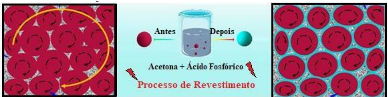
Figura 4 – Diagrama esquemático da perda de corrente parasita reduzida pela camada de revestimento de isolamento efetivamente integrada
