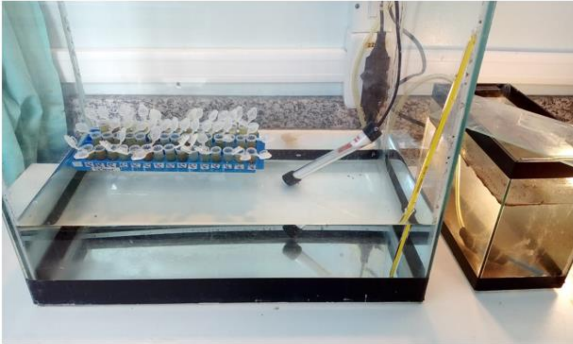
Figura 4 – Aquário com os tubos de ensaio, contendo os náuplios de Artemia salina , expostos aos extratos, com controle de temperatura e luminosidade, por um período de 6 horas.
