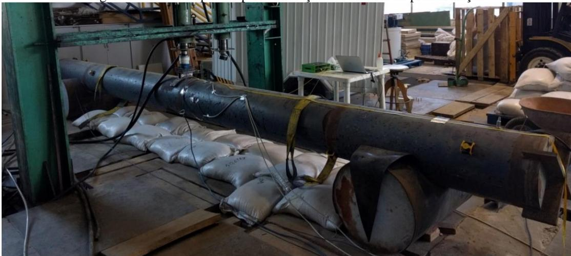
A execução dos ensaios experimentais consistiu na pressurização da água dentro do duto até a pressão manométrica de 10 MPa, seguida da manutenção dessa pressão por alguns minutos. Nesse ponto, se avaliou as deformações máximas lidas pelos extensômetros. Em seguida a pressão interna foi removida. Primeiramente se fez esse procedimento com o duto
