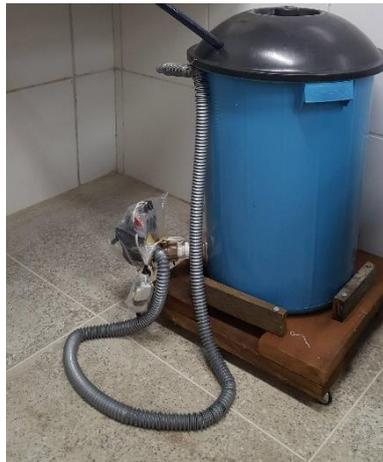
Foi utilizado um saco de tecido com 10 g as sementes da moringa na saída da mangueira do sistema para simulação de filtro de fácil acesso de famílias de baixa renda (Figura 4). Nesta montagem o volume 1 litro de água barrenta coletada no município de Pacatuba foi diluído para 10 litros, usando água destilada. O sistema ficou em funcionamento por 50 minutos.
